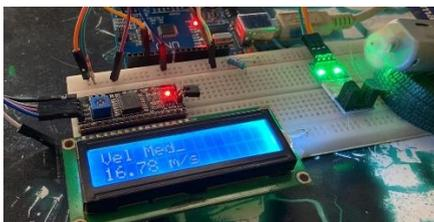
Fig. 21 Montaje encoder optico de velocidad
